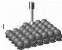
Рис. 11.3. Игла сканирующего туннельного микроскопа, выходящая на постоянное расстояние ( a ) над слоями атомов исследуемой поверхности
