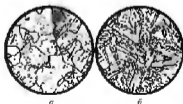
Рис. 2.9. Микроструктуры технического титана: а — после отжига, 100-кратное увеличение, б — после закалки, 300-кратное увеличение
