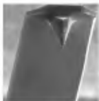
Рис. 11.2. Микрофотография конца кантайлера с шипом (увеличение 1000-кратное)
